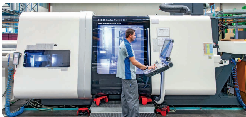
Drehfräszentrum CTX DFZ SK ausgelegt für eine 6-Seitenbearbeitung im Werk Brandenburg der Heidelberger Druckmaschinen AG
