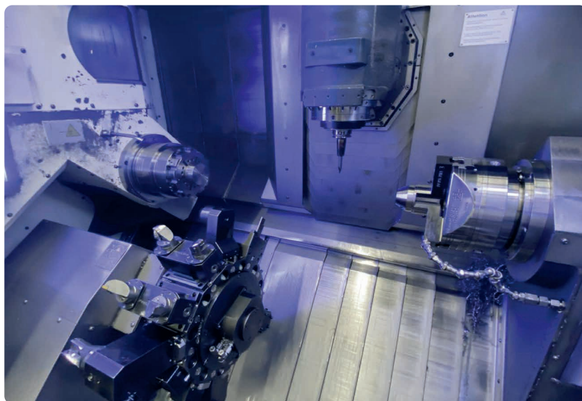
Blick in den Arbeitsraum des Drehfräszentrum CTX DFZ SK ausgelegt für eine 6-Seitenbearbeitung im Werk Brandenburg der Heidelberger Druckmaschinen AG
